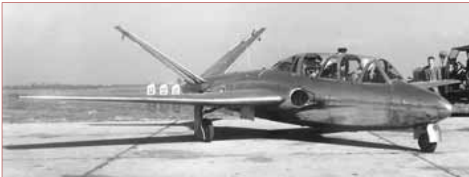
Le prototype 03/Q (F-ZWRQ) lors d'une check-list prévol. À noter les aérofreins sortis. (coll. J. Delmas)
