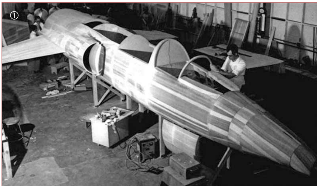
① La maquette à l'échelle 1/1 du Model 083 en cours de fabrication par les ébénistes de l'avionneur. (Lockheed)
