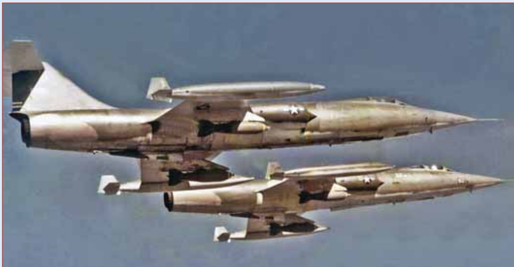
L'utilisation du F-104C pour des missions air-sol n'était pas des plus économiques car il ne disposait que de deux points d'emport (ici avec bombes M117 de 340 kg) sous sa voilure. (Usaf)
