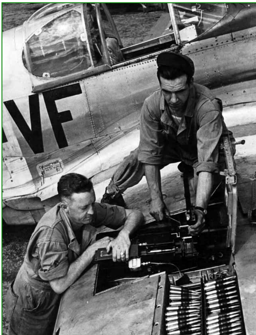
Les armuriers du 336 th Fighter Squadron, 4 th Fighter Group, réapprovisionnent les mitrailleuses d'un P-51B équipé d'une verrière Malcolm. (USAAF)
