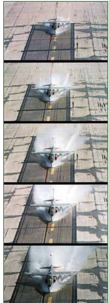
Essais sur piste inondée à Brétigny. (photos Dassault)
