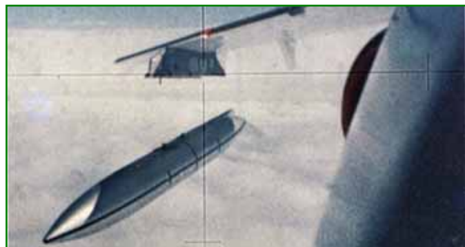
Essais de largage de charges externes. (photo Dassault)
