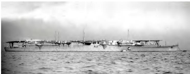
Le *Taiyō*, chef de file d'une classe de trois porte-avions d'escorte, était un ancien cargo – *Kasuga-Maru* – qui déplaçait 18 120 tonnes à la vitesse maximale de 21 nœuds. Long de 180 m et large de 22,5 m, sa structure convenait davantage à un rôle logistique que le commandement allait logiquement lui attribuer. (Archives auteur/DR)
