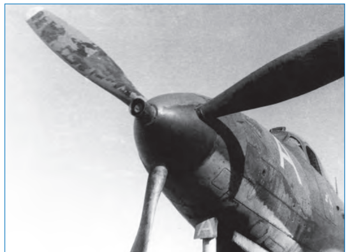
Détail du cône de l'hélice avec la bouche du canon de 37 mm sur l'Airacobra «A» de l'Ardennes. (Photo C. Trescases)
