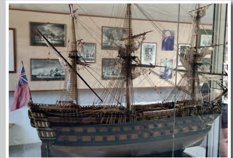
Le vaisseau de ligne HMS Formidable, navire amiral de la flotte anglaise. Le revêtement de cuivre de la carène est bien visible. (Maquette au Fort Napoléon, aux Saintes — JLF)
