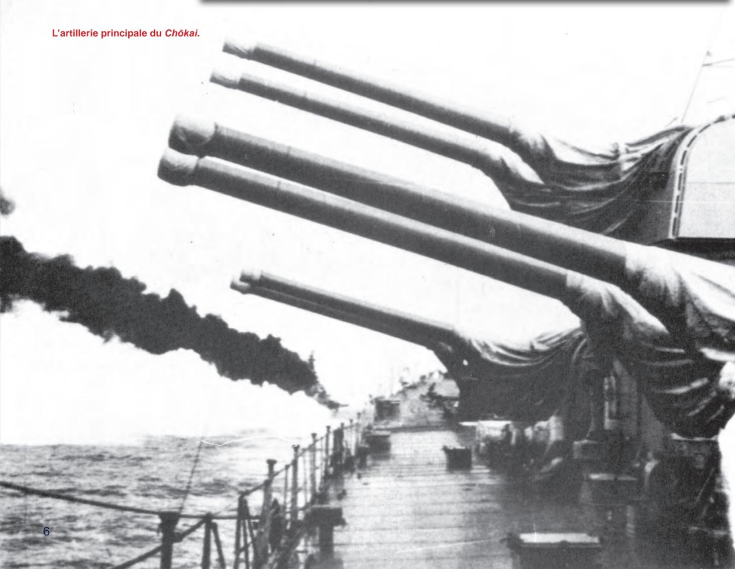
La vitesse d'élévation des pièces de 203 mm est de 12°/s. La vitesse de rotation est de 4°/s.
