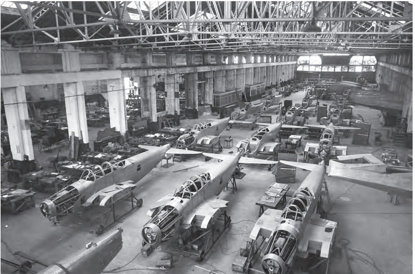
Le hall d'assemblage de l'usine Latécoère de Biscarosse en 1938. On distingue au premier plan la partie arrière du fuselage du n° 1 et, immédiatement derrière, les exemplaires n° 2, 3 et 4. (© Musée de l'Hydraviation)
