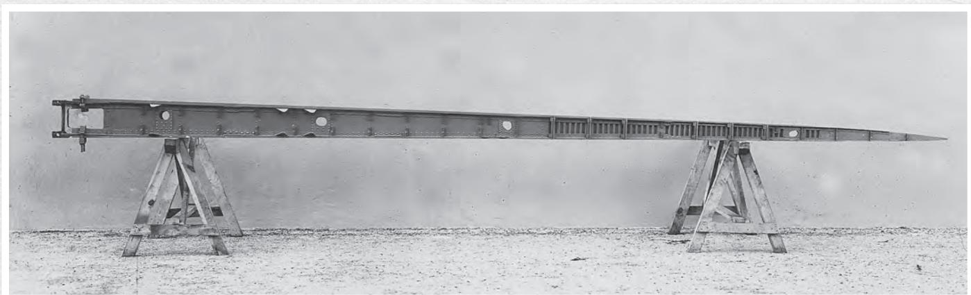
Longerons avant et arrière de voilure du type 298 B (voilure repliable)
