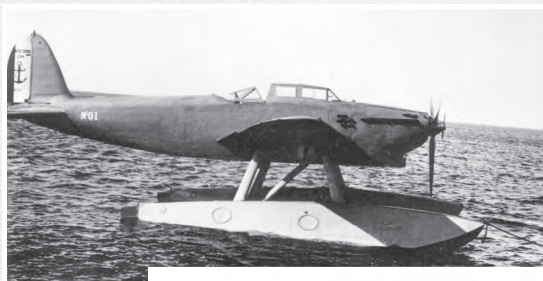
Le Latécoère 298 N° 01 est photographié ici à l'époque de son premier vol en 1936. Il est caractérisé par l'hélice Ratier à moulinet remplacée plus tard par une autre à commande électrique. (Coll. JC. Soumille)
