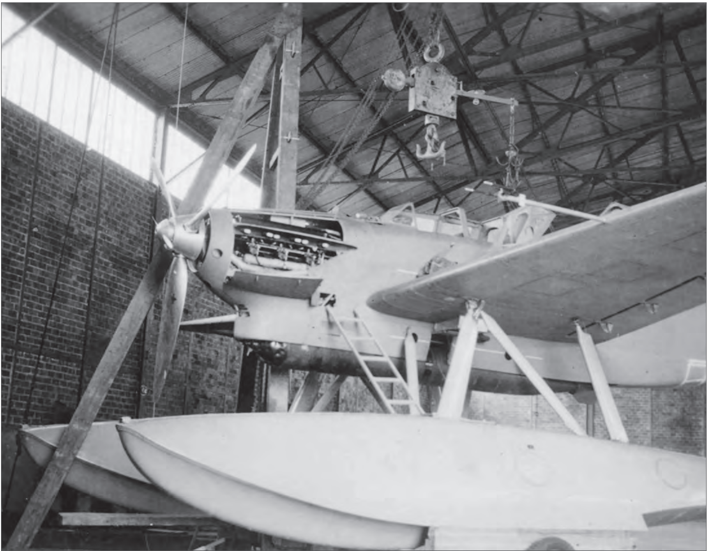
La vérification de la masse. Accroché à un peson dans l'un des hangars de l'usine Latécoère, le prototype du 298 est ici photographié lors des pesées à pleine charge ainsi que le poutre la torpille montée dans la soute. (@ Musée de l'Hydraviation)
